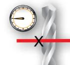
**刀具跳动:** 实时测量刀具的跳动, 虚拟千分表和数显表同时显示测量结果。
