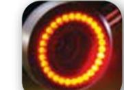
**刀具表面检查:** 通过刀具表面检查灯, 可以检查刀具表面的磨损、裂痕、积屑瘤等状况。
